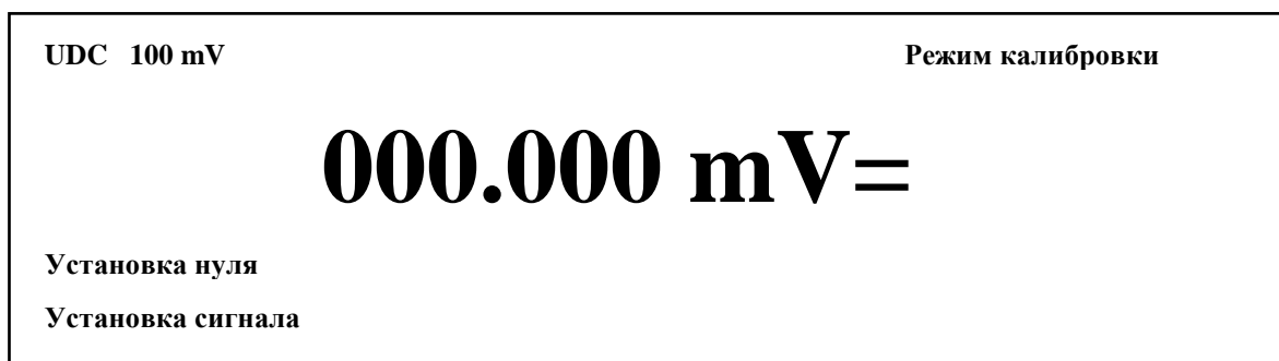
Рисунок А.2 - Изображение информации на дисплее вольтметра в режиме “КАЛИБРОВКА” при измерении напряжения постоянного тока на диапазоне 200 мВ.
