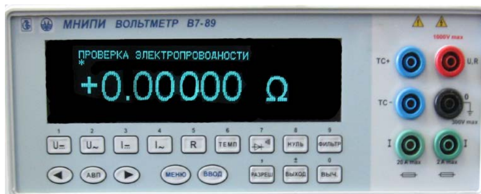
Рисунок 22 - Изображение информации на табло в режиме прозвонки электрических цепей на короткое замыкание
