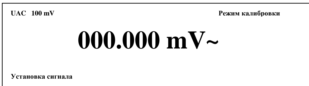
Рисунок А.6 - Изображение информации на дисплее вольтметра в режиме “КАЛИБРОВКА” при измерении напряжения переменного тока на диапазоне 200 мВ.
