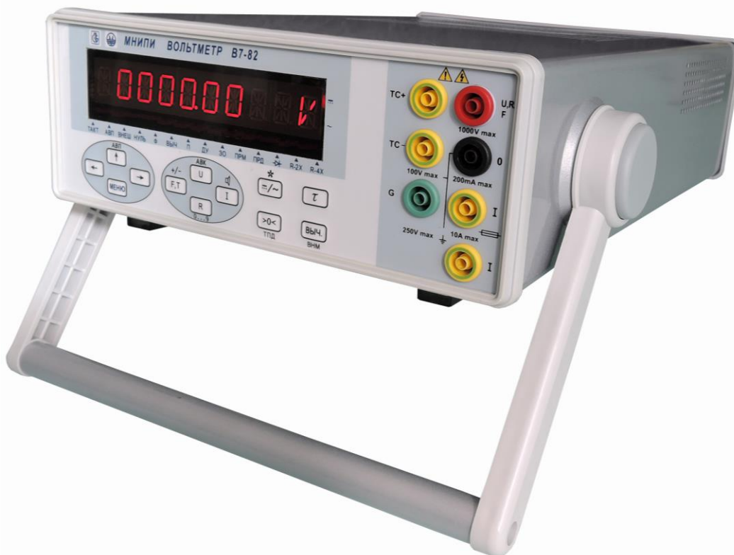
Рисунок 1 - Вольтметр универсальный В7-82. Внешний вид
