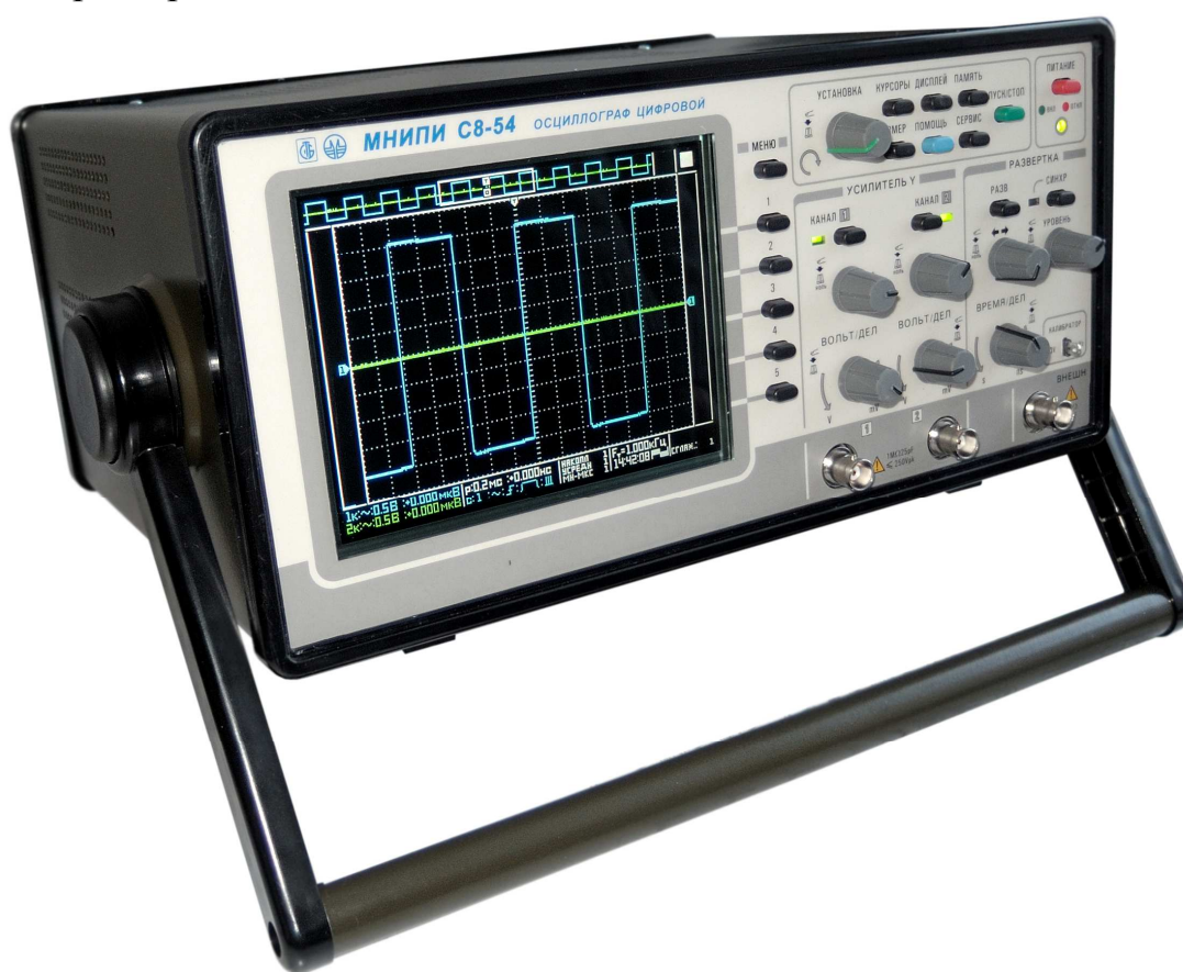
Рисунок 1.1 – Осциллограф цифровой С8-54. Внешний вид
