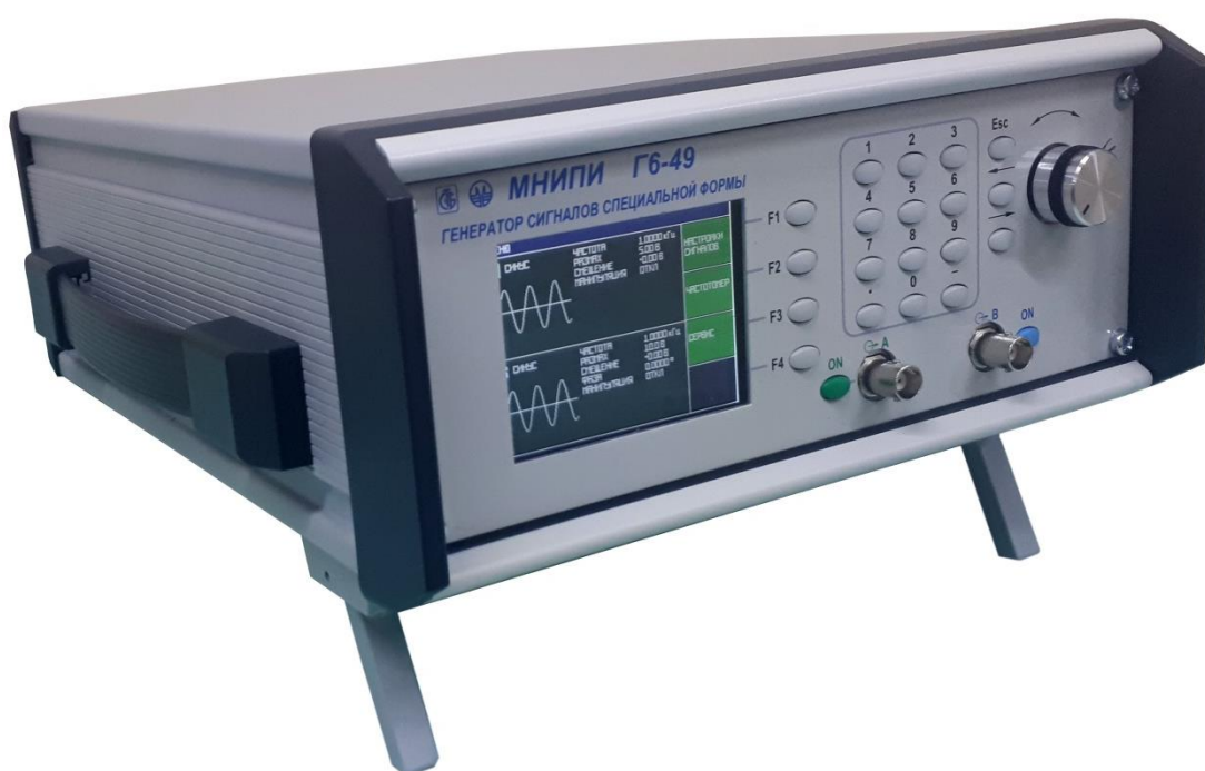
Рисунок 1.1 – Генератор сигналов специальной формы Г6-49. Внешний вид
