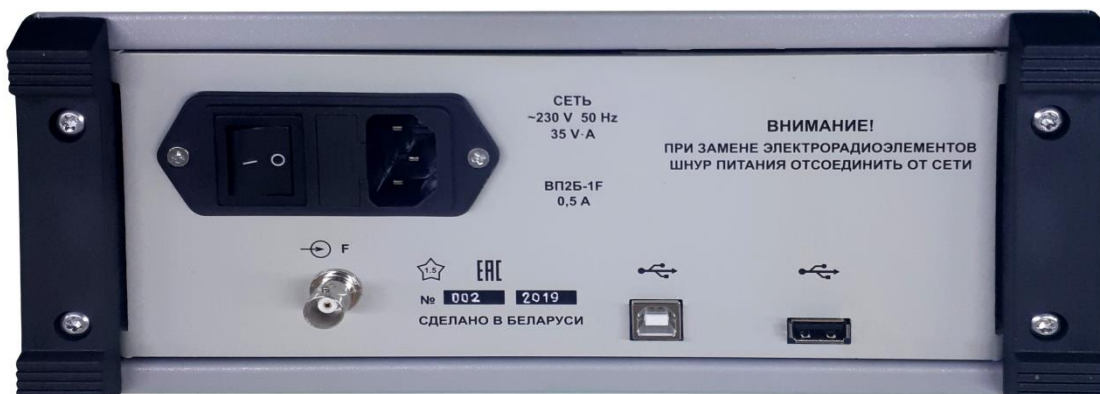
Рисунок 2.2 – Задняя панель генератора
