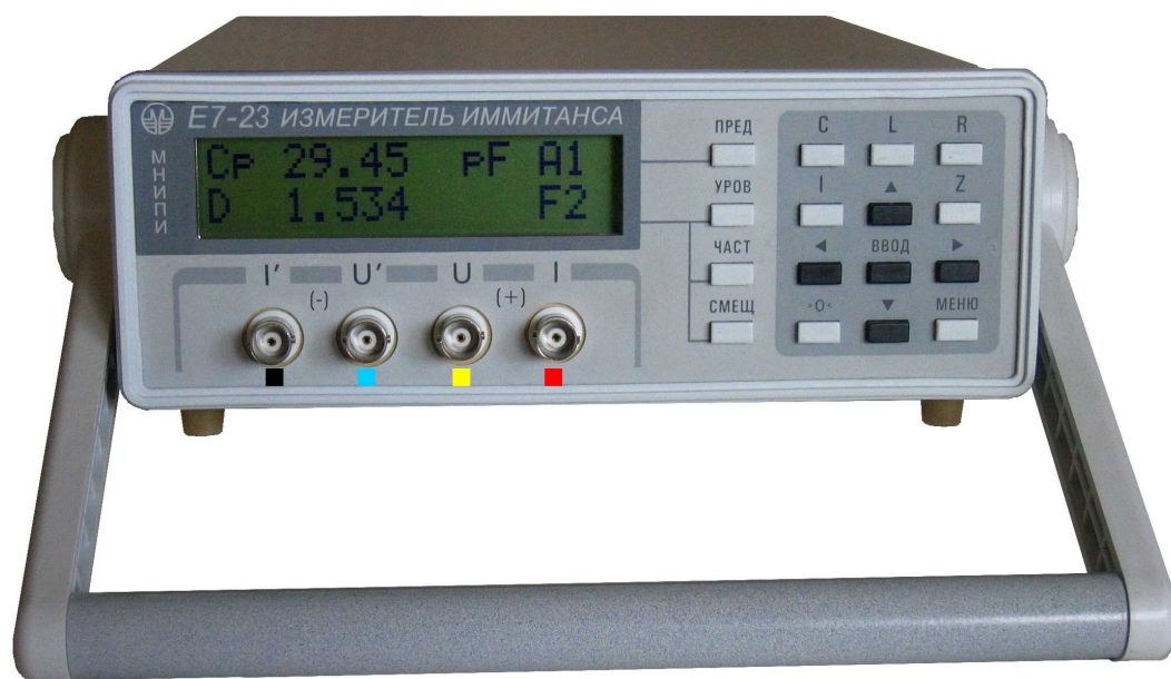
Рисунок 1.1 – Измеритель иммитанса Е7-23. Внешний вид
