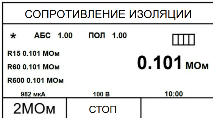
Рисунок 3.10 – Измерение сопротивления изоляции с вычислением коэффициента абсорбции и поляризации
