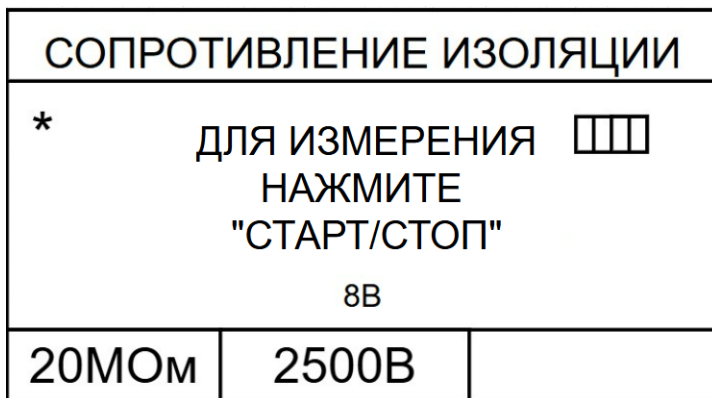
Рисунок 3.6 – Режим измерения «Сопротивление изоляции»
