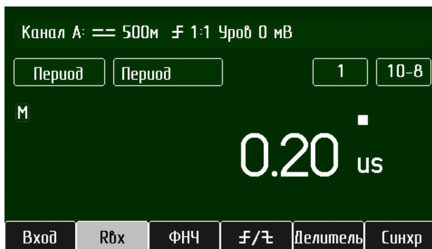
Рисунок 2.5 – Вид экрана при измерении периода сигнала
