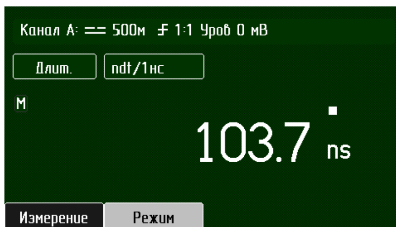
Рисунок 3.12 – Вид экрана при измерении длительности в режиме "nΔt/1нс"
