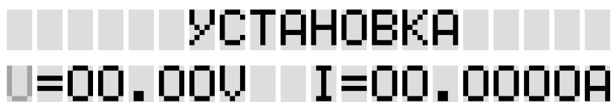
Рисунок 4 – Состояние источника питания УСТАНОВКА
